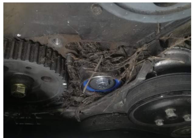
Αποτέλεσμα μη τοποθέτησης της ροδέλας
