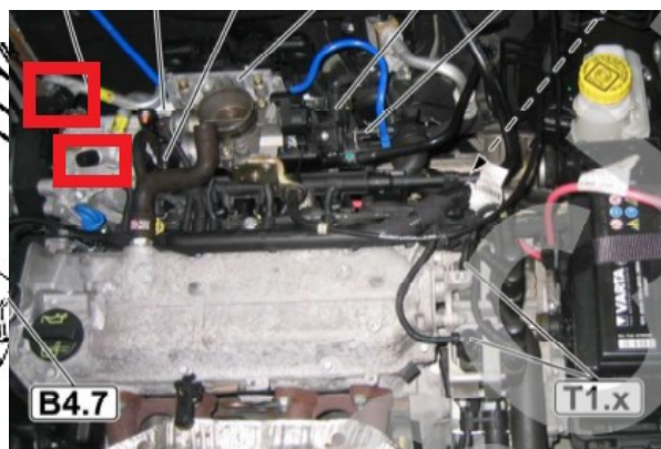
Βαλβίδες πλήρωσης φρέον.
